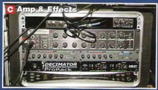
C Amp & Effects ▲最上段左はDIで、右がロールズのシグナル・プロセッサー"SX21"。その下から、高消費のプリ・アンプであるピアース・エレクトロニクスの"BC1"、アシュリーのコンプレッサー/リミッター"CLX-52"、ISPのノイズ・リダクション・システム"Decimator"、コルグのチューナー"DTR-2000"。
