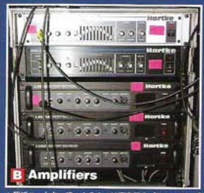
B Amplifiers ▲総てハードキーで、上の2つは高消費のパワー・アンプ "HA5500" (下側がスベア)、下の3つは低消費の "LH1000" (真ん中にはコンプレッサーを接続、一番下がスベア)。
